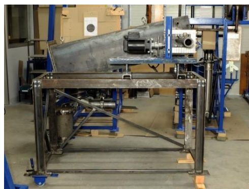
Rysunek 51. Ekspander ORC niskociśnieniowy z generatorem oraz systemem wtrysku oleju i separacji
