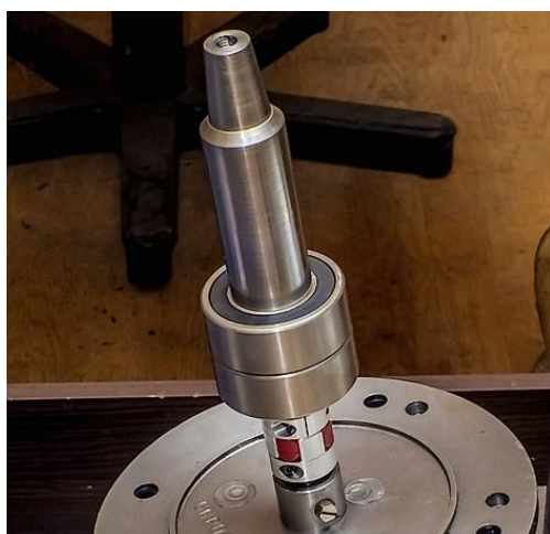
Rysunek 24. Stożkowa końcówka osi z łożyskami
