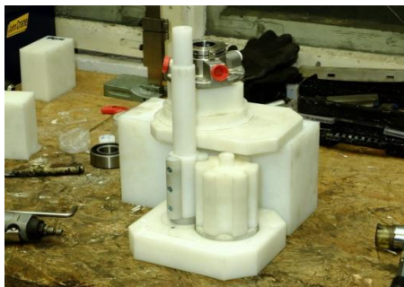
Rysunek 41. Model obrotowy z hermetycznym uszczelnieniem
