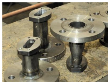
Rysunek 19. Hermetyczne rury przyłączeniowe. Wlot i wylot
