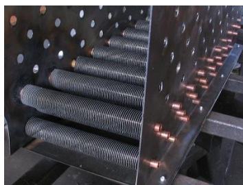
Rysunek 32. bimetalowe rury żebrowane
