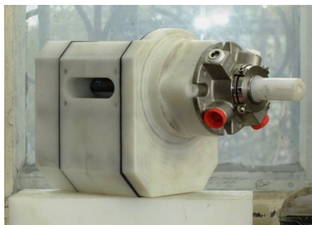
Rysunek 42. Zamknięty model z wbudowanym hermetycznym uszczelnieniem
