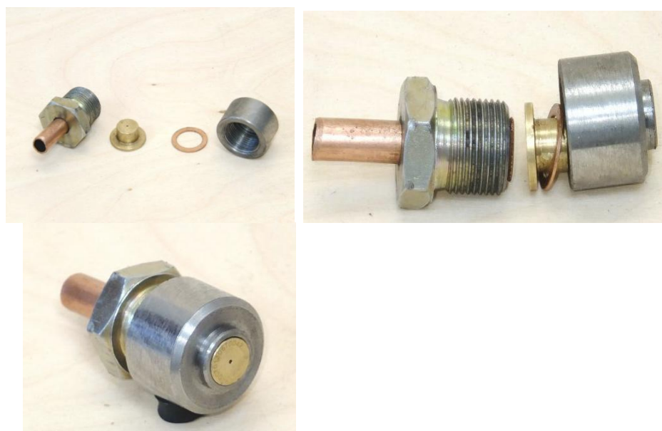
Rysunek 31. Hermetyczne dysze do wtrysku oleju
