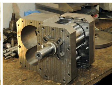
Rysunek 43. Ekspander ORC z zamontowanym wirnikiem
