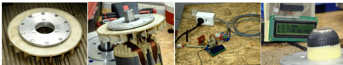
Rysunek 26. Dysk z aluminium i magnesy zamontowane na generatorze podłączony do rezystorów i elektroniki
