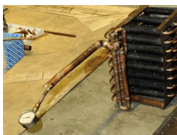
Rysunek 35. Próby ciśnieniowe gotowych modułów
