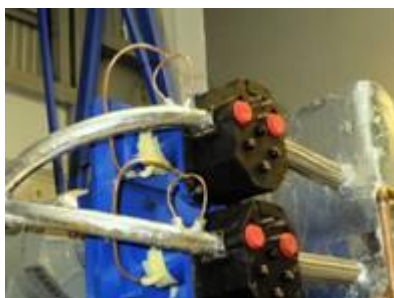
Rysunek 30. II wersja podwójnego system transmisji z hermetyzacją na osi
