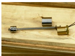
Rysunek 46. Miernik poziomu czynnika z niestandardowo wykonanym złączem hermetycznym
