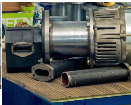
Rysunek 23. Zamontowana hermetyczna obudowa wału
