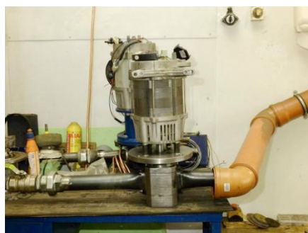
Rysunek 45. Testy ekspandera ORC ze sprężonym powietrzem
