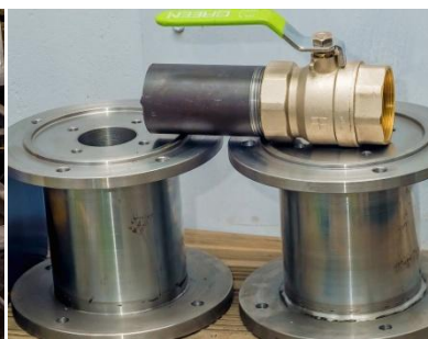
Rysunek 22. Hermetyczne obudowy wałów
