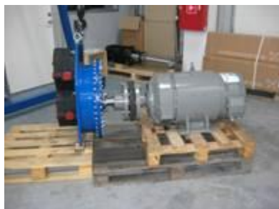
Rysunek 29. I wersja podwójnego systemu transmisji z hermetyzacją przekładni
