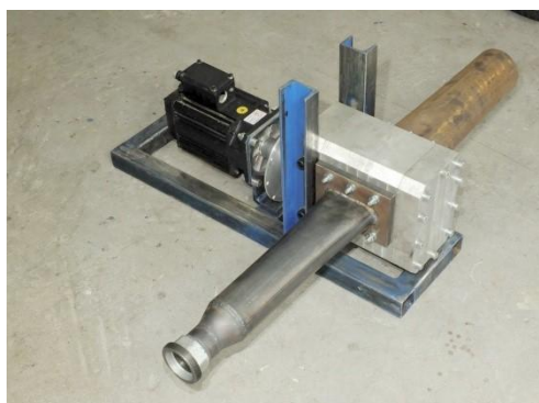
Rysunek 50. Ekspander ORC niskociśnieniowy z generatorem
