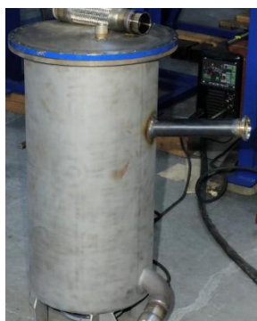
Rysunek 28. Zbiornik płynu roboczego
