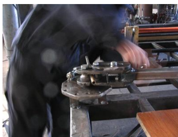
Rysunek 33. Ręczne gięcie rur miedzianych
